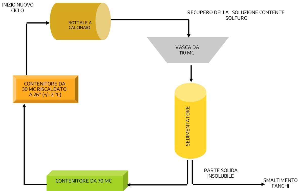
Alla fine di ciascun ciclo di calcinaio la soluzione contenente solfuro residuo viene recuperata e quindi immessa in una vasca di contenimento da 110 m<sup>3</sup>. Da questa la soluzione passa in un sistema di sedimentatori il cui volume è pari a 100 m<sup>3</sup> per togliere la parte solida insolubile (calce insolubile, sabbia, terra ed altro) smaltita come fango.
